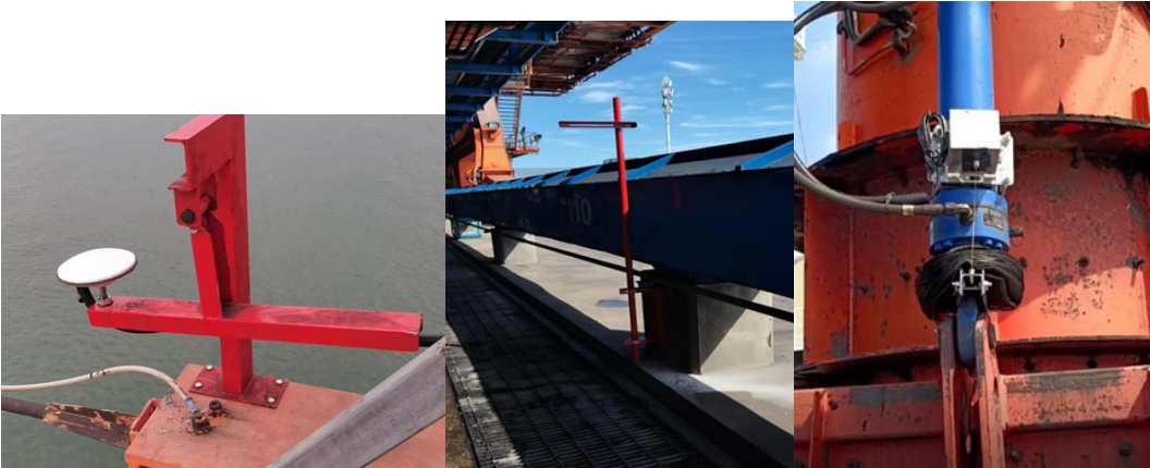
图 12 北斗定位、走行校正、角度检测装置
