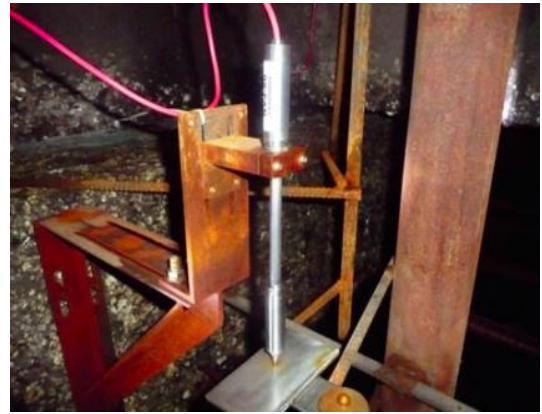
图 2 原型试验的单点位移计
