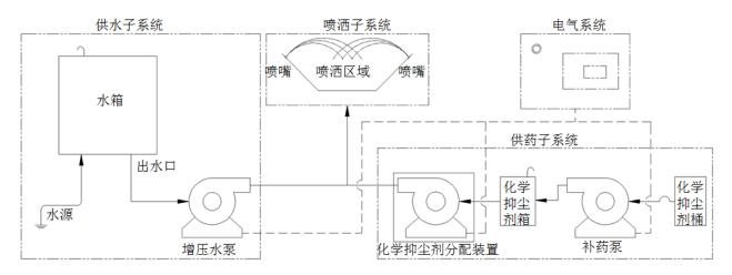
注: 箭头方向为连接管道内供水和化学抑尘剂流向。
